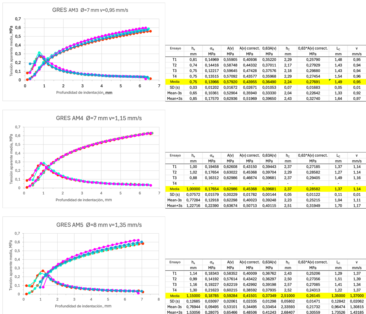
Figura 3. Respuesta de la composición de gres sometida al ensayo de indentación confinada: curvas superiores \sigma_{ap} ; curvas inferiores d\sigma_{ap}/dh . La numeración y orientación de los puntos son las mismas empleadas con las probetas de porcelana que se muestran en la Figura 2.
