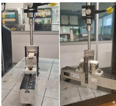
Figura 7. Ensayo de flexión en tres puntos
